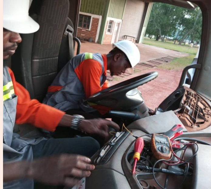
Installation d'une balise GPS dans un camion
